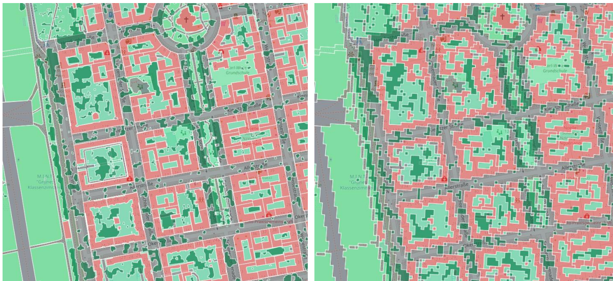
Abbildung 4: Eingangsdaten in der PALM-4U GUI: Editierbare vektorbasierte Eingangsdaten in der PALM-4U Eingangsdatenklassifizierung (links) sowie daraus auf der GUI gerasterte PALM-4U Eingangsdaten für den static driver (rechts). Quelle: Fraunhofer-Institut für Bauphysik IBP 2022
