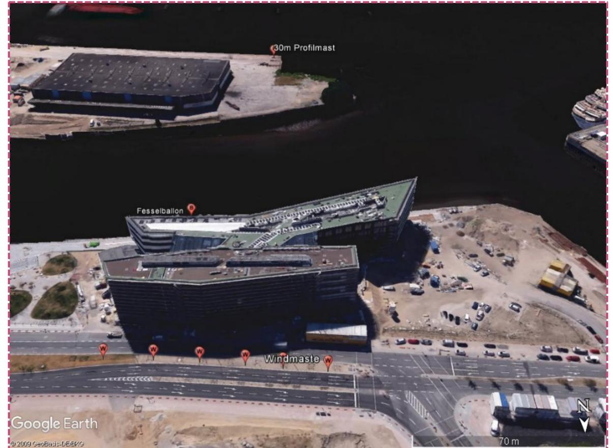
Gleichzeitige Messungen an mehreren Stellen im Untersuchungsgebiet. Windmaste in der Straßenschlucht (W), Aufstieg eines Fesselballons bis 400 m Höhe vom Dach eines Gebäudes (B) und Profilmast mit Messungen bis 30 m Höhe zur Bestimmung der Anströmung (P) (Quelle: Google Earth/ Universität Hamburg).
